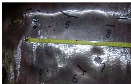
Рис. 1. Трещины в станине (фотография сделана специалистами ЗАО «Прочность» при выполнении экспертизы технического состояния силовых деталей кузнечно-прессового оборудования перед проведением модернизации)
